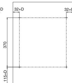
D – размер наложения фасада на боковую стенку каркаса
