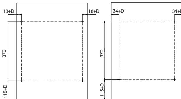
D – размер наложения фасада на боковую стенку каркаса
